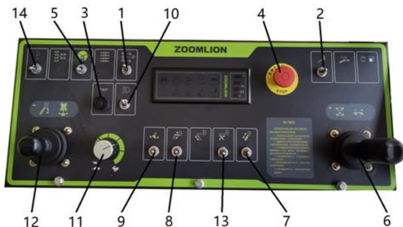
Fig. 2-9 Panel de control de la plataforma (solo están numerados los interruptores con una función ya existente)
